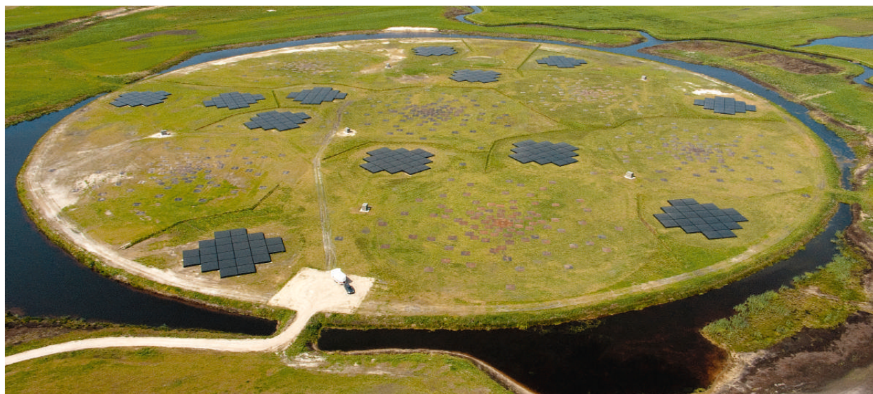
Projektbeispiel aus dem EFR: LOFAR, Low Frequency Array, ein Weltraum-Radioteleskop aus miteinander vernetzten Antennenfeldern von Irland bis Polen. Besonders viele Stationen stehen in Deutschland und in den Niederlanden wie hier nahe Exloo.
